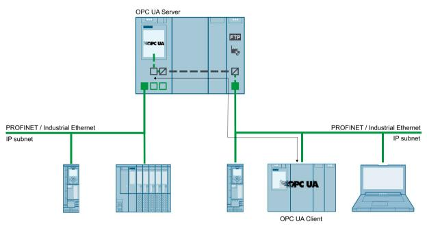
Figure 10-2 Example: Access of OPC UA clients to the OPC UA server of the CPU
